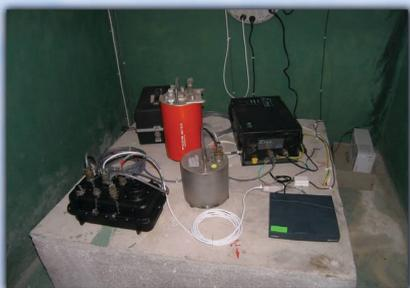
Сеизмометри и акселерометри в сеизмична станция.
