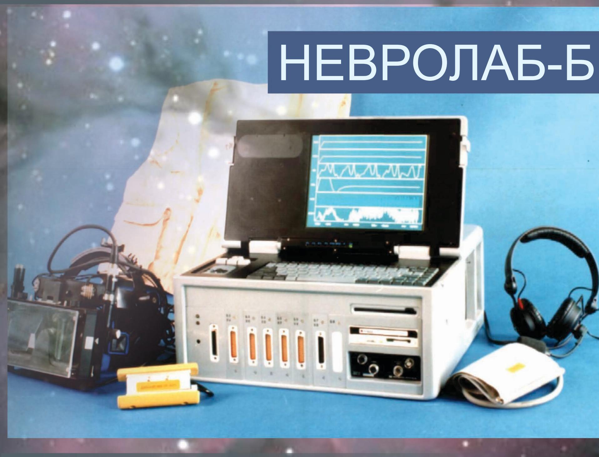
НЕВРОЛАБ-Б е изграден на модулен принцип с възможност за бързо конфигуриране и реконфигуриране в зависимост от типа на провежданите експерименти.
